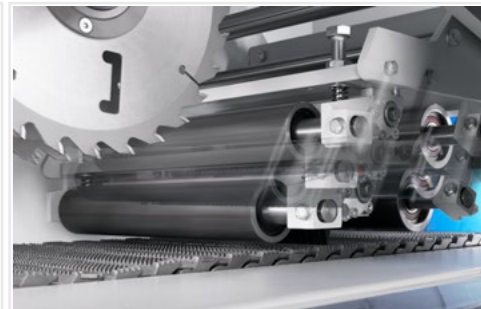
Elektrische Höhenverstellung des Druckwerks: hoher Bedienkomfort
