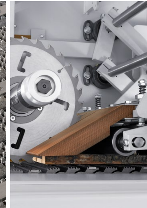
Druckbrett: perfekte Schnittqualität auch bei kurzen Hölzern
