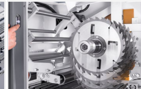
Elektrische Höhenverstellung der Sägewelle: hoher Bedienkomfort
