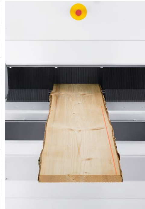
Laser zur Schnittanzeige: sehen, was gesägt wird
